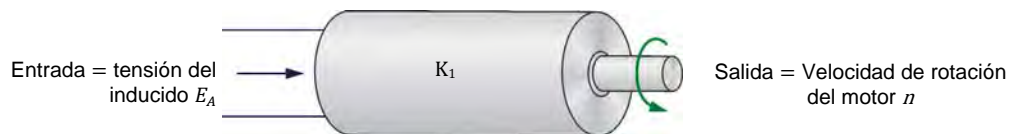
Figura 2-11. Motor cc como convertidor de tensión a velocidad.
